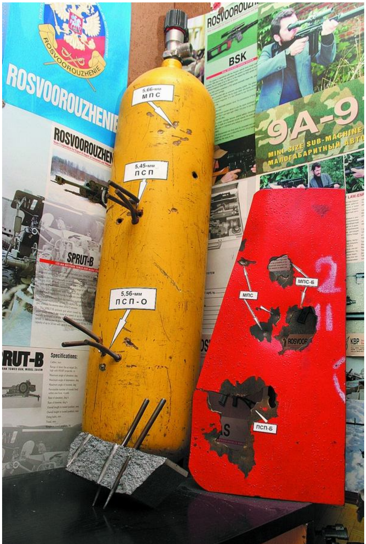
Примеры подводных испытаний нового АДС (данных о глубине и дальности не нашел, по новым боеприпасам ПСП-О, ПСП-Б дополню позже)
