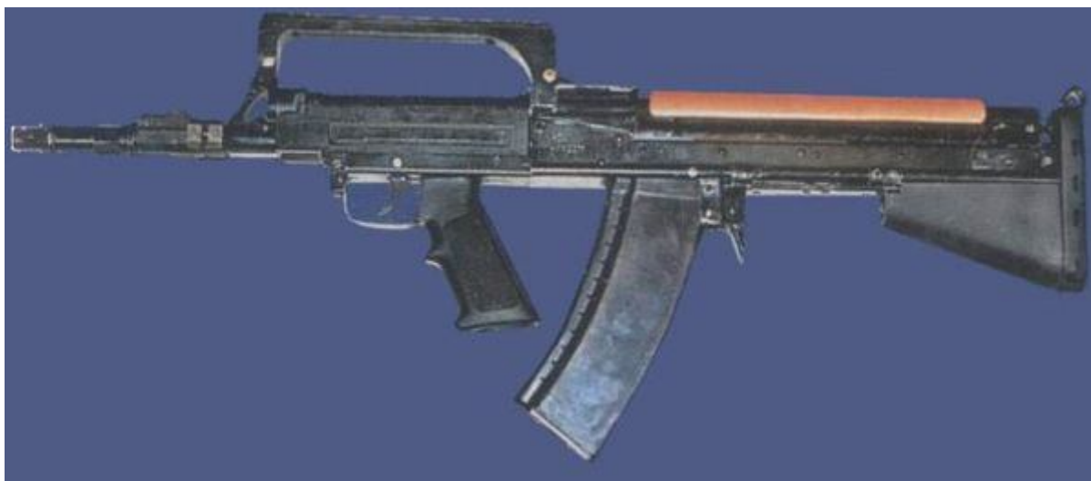
Один из ранних опытных образцов автомата АДС (А-91), созданный на базе автомата АСМ-ДТ, в конфигурации для стрельбы "на воздухе"
