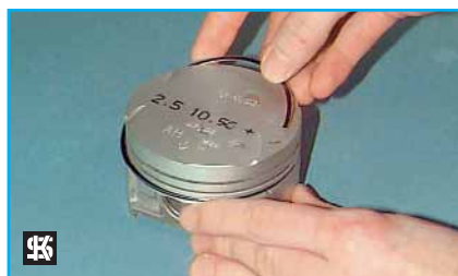
Segmento de engrase de laminillas de acero
