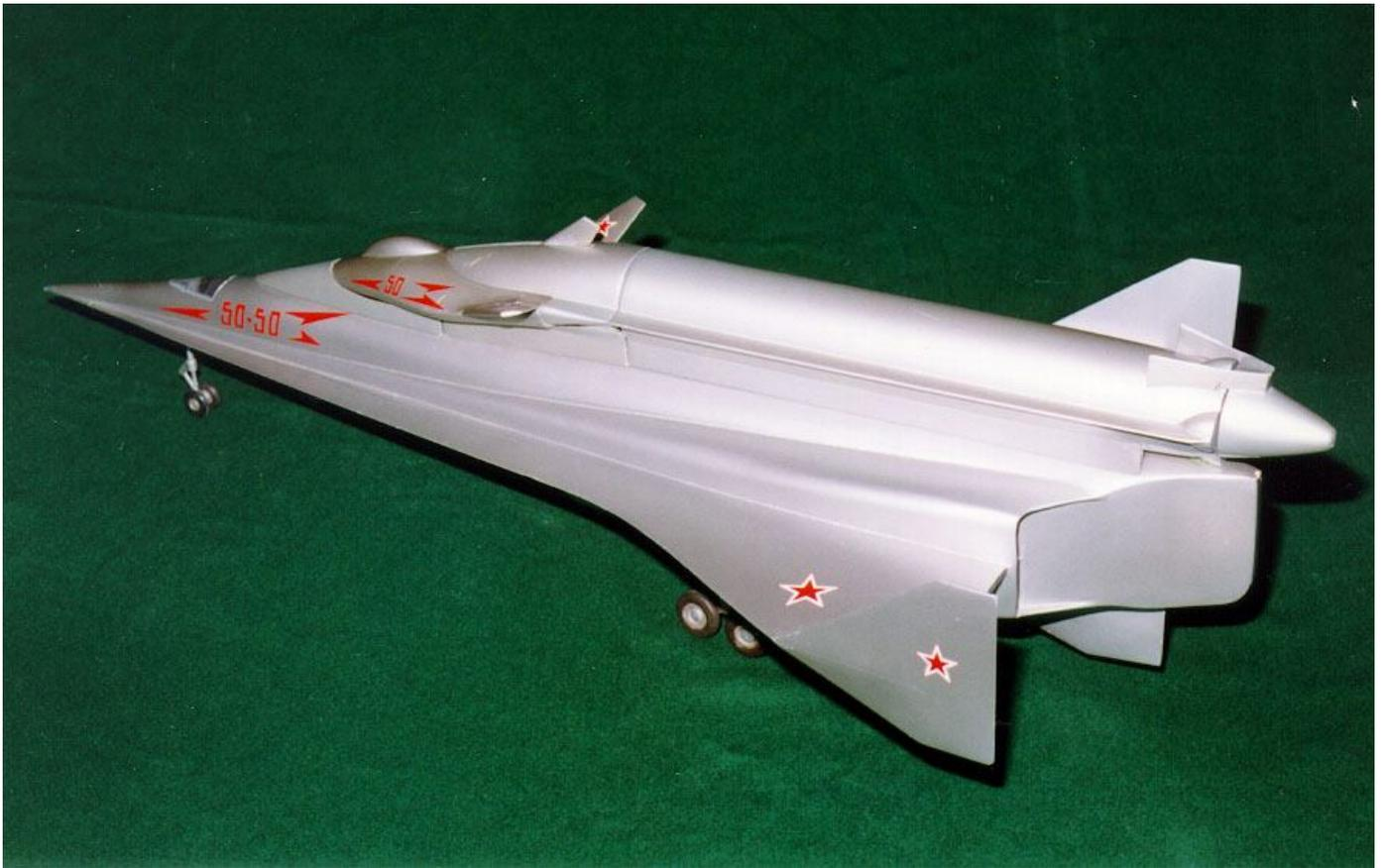
В соответствии с требованиями заказчика конструкторы взялись за разработку многофазового двухступенчатого ВОС, состоящего из гиперзвукового самолета-разгонщика (ГСР) и военного орбитального самолета (ОС) с ракетным ускорителем.
